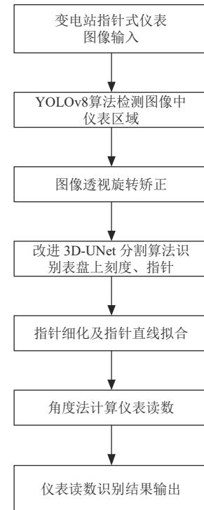
图 1 指针式仪表检测与读数识别流程
