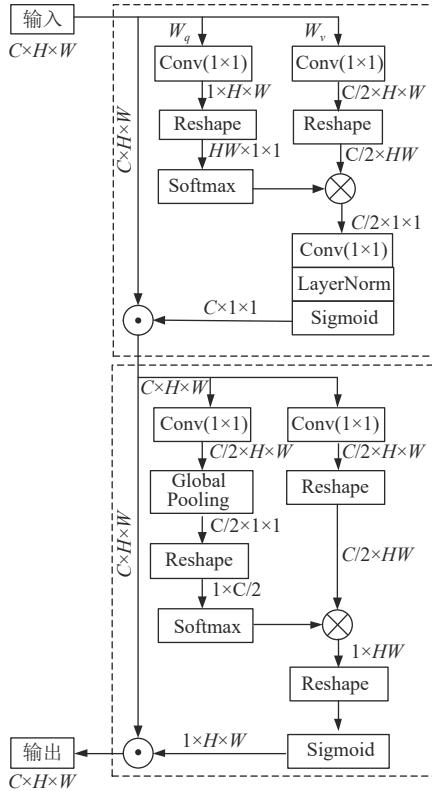
图3 PSA 注意力模块网络结构
