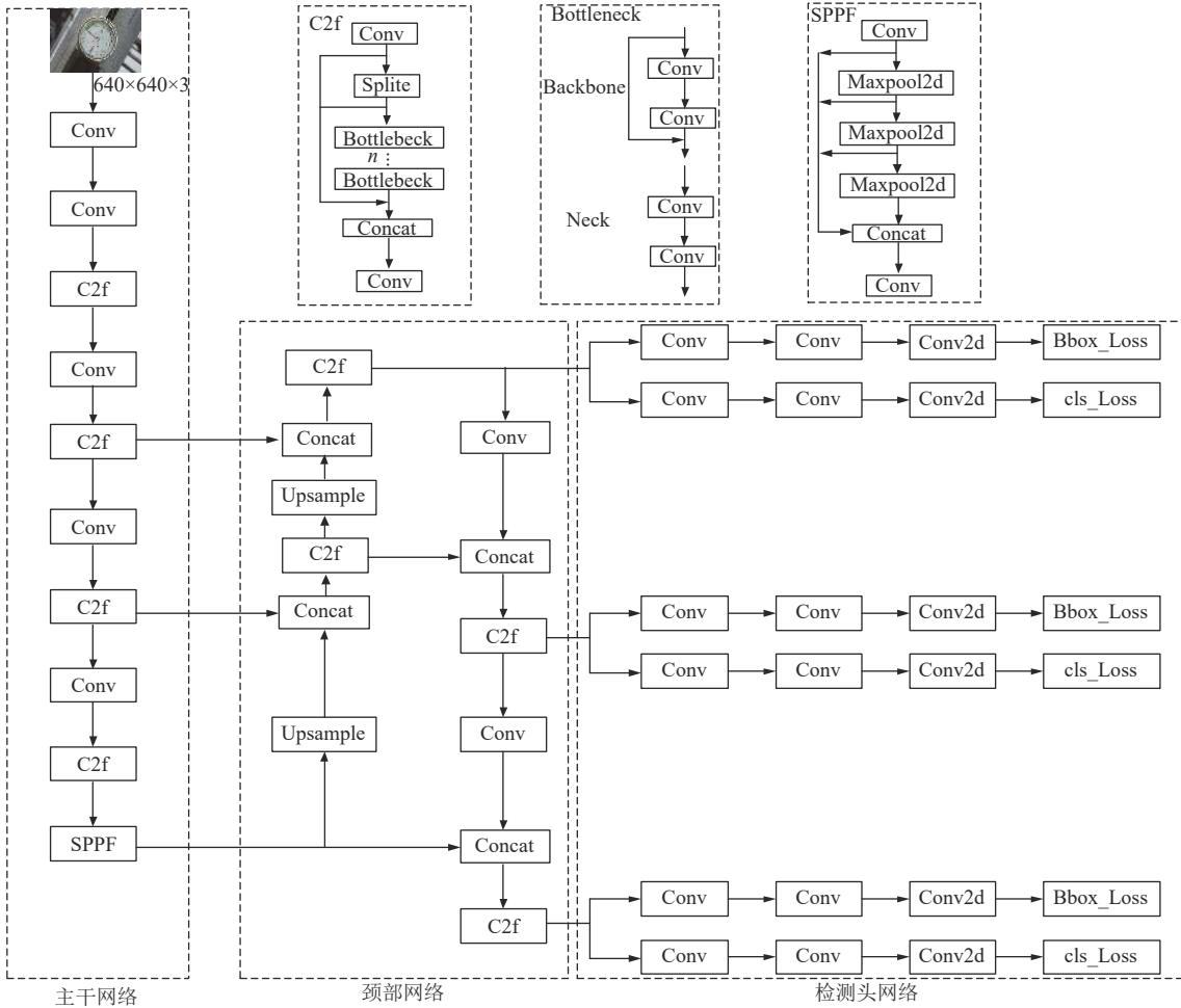
图 2 YOLOv8 网络结构
