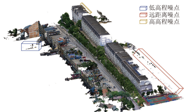
图1 图像点云噪点示例
