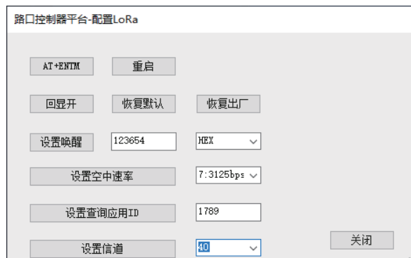
图 9 LoRa 设备的详细配置
