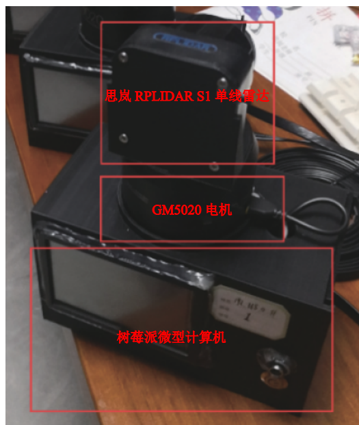
图 2 单套集成激光雷达点云采集设备
