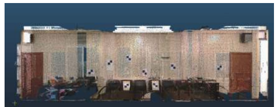
(a) 高精度三维静态扫描点云
