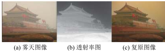
图3 引导滤波算法去雾
