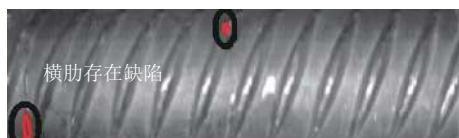
图 13 横肋图像检测结果
