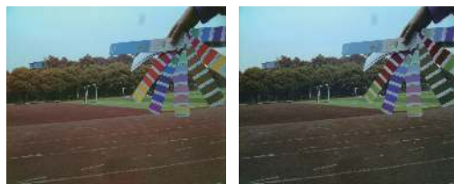
图7 操场四带图像经优化的三元一次(左)和三元二次(右)校正算法校正后图像
