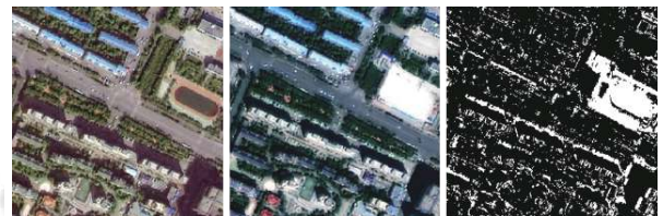
图6 不同时相影像中建筑物阴影干扰造成的伪变化
