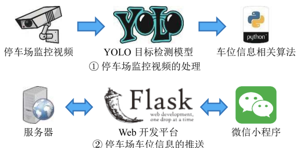
图2 智能停车场车位查询系统结构
