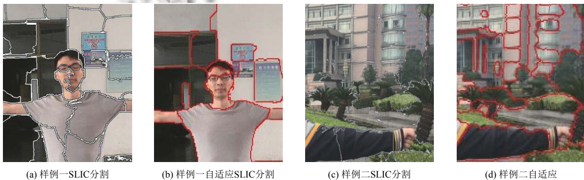
图 3 传统 SLIC 算法与改进后的 SLIC 算法对比
