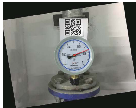
(c) 普通压力表使用仪表校正和提取表盘所在区域算法
