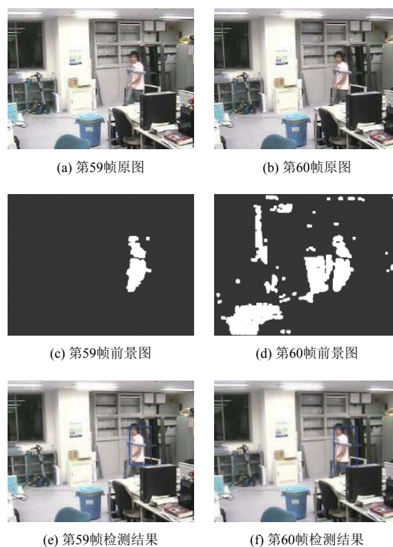
图 4 光线变化对目标检测效果的影响
