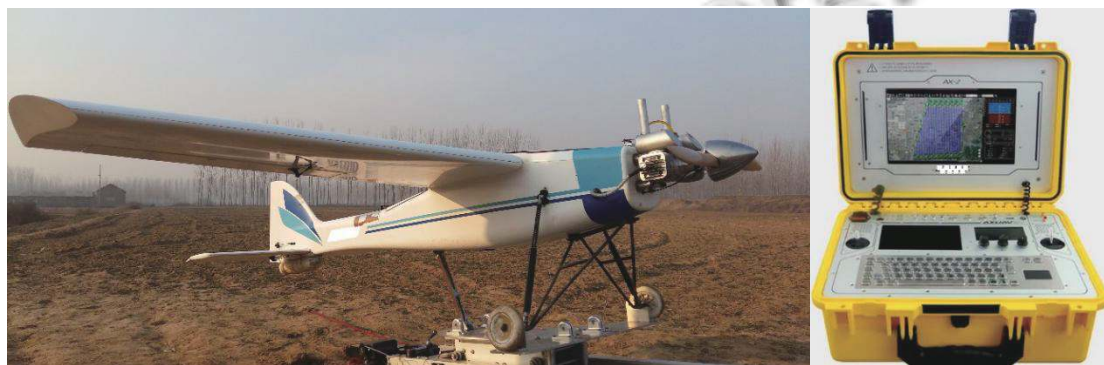
图2 固定翼油动飞行器和地面飞行工作站
