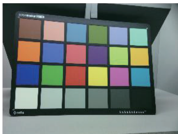
图7 通过校正矩阵获得的图片 (色卡)
