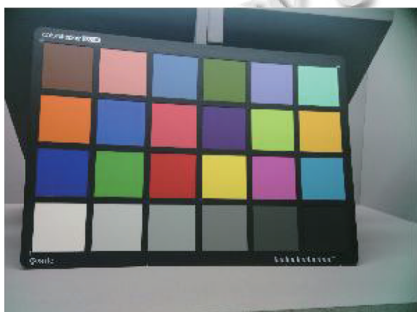
图5 D65+850 nm 有红外滤镜 (色卡)
