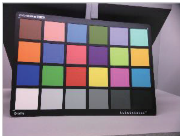
图6 D65+850 nm 无红外滤镜 (色卡)
