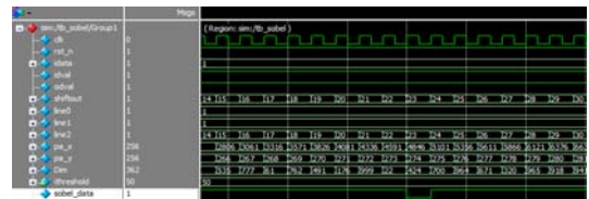
图 14 Sobel 边缘检测时序仿真图
