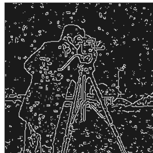
图 1 噪声条件下 Canny 算子得到的强边缘图
