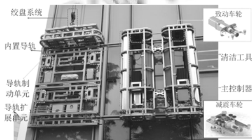
图 2 建筑物表面清洁机器人机械结构图
