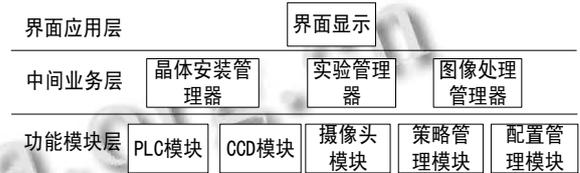
图2 操作与控制系统模块结构图
