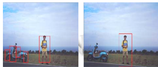
(a) 正样本 1200 个, 负样本 2000 个 (b) 正样本 2400 个, 负样本 12000 个
