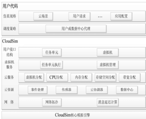
图 2 Cloudsim 软件框架的多层体系结构
