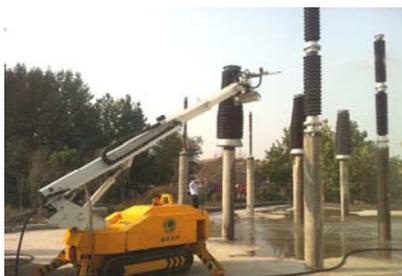
图 10 模拟冲洗试验图
