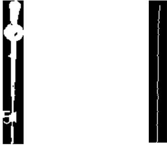
(a)提取感兴趣区域 (b) 滤波细化后的指针图像
