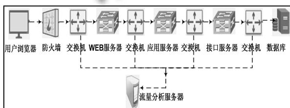
图1 流量监测数据采集原理图
