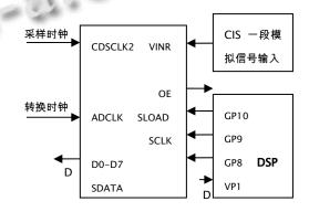
图 5 模数转换部分电路框图
