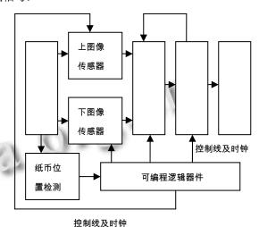
图 3 系统硬件结构框图
