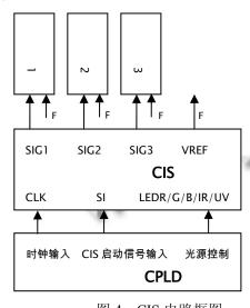
图 4 CIS 电路框图
