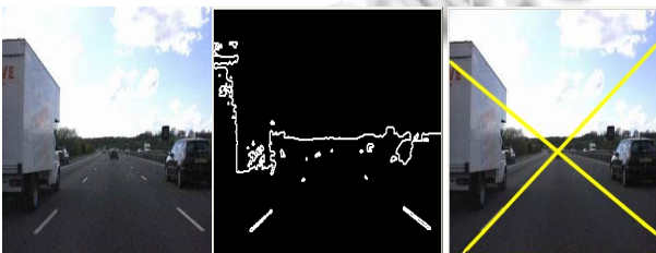
图 7 有车辆遮挡的车道线识别过程
