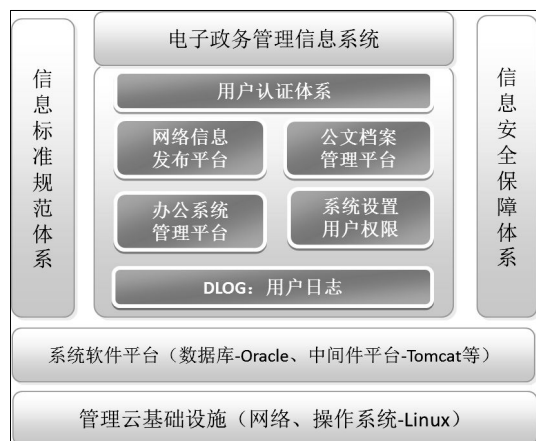
图 1 电子政务管理信息系统整体架构示意图
