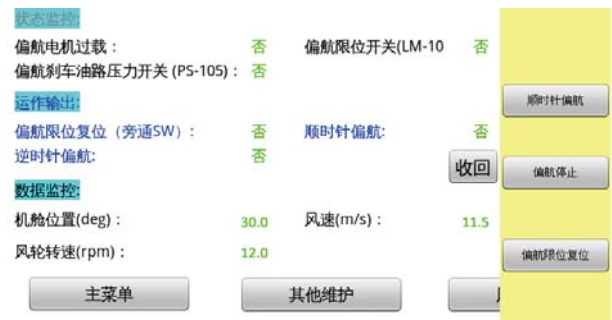
图 7 某子系统监控与维护画面
