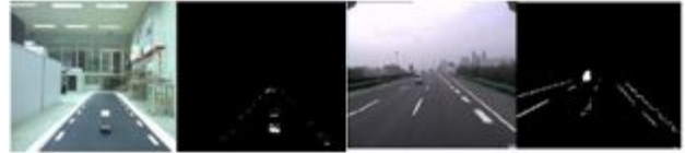
图 6 基于路面灰度的车辆识别预处理结果
