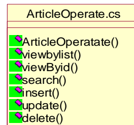
图 4 ArticleOperate.cs 类（文章控制类）的方法类图
