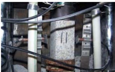
图9 正在做岩样11号的受压实验
