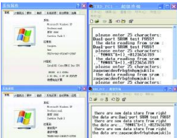
图8 共享双口RAM的数据通信测试结果
