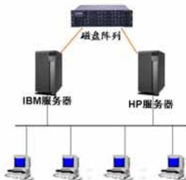
图 1 IBM DS400 存储组网拓扑图
