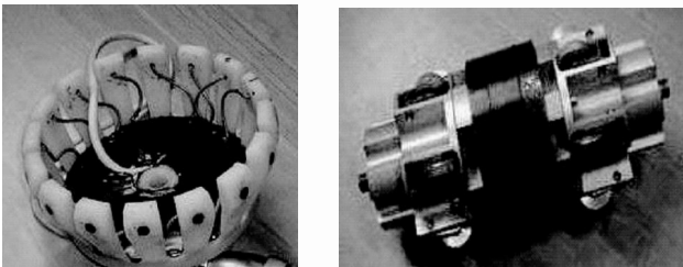
图 2 磁记忆(左)和漏磁(右)传感器
