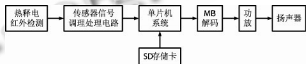
图 1 人体接近智能电子解说系统结构框图
