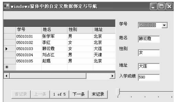
图 1 下拉列表框实现 DataGrid 与文本框显示内容的同步
