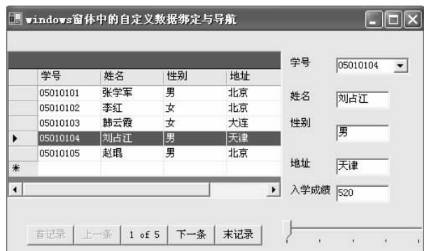
图 2 选择 DataGrid 控件中任何一条记录实现 DataGrid 与文本框显示内容的同步
