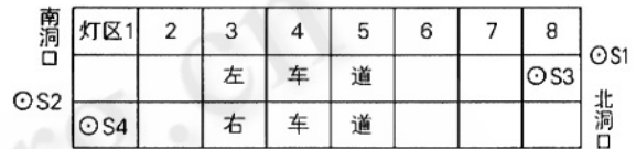
图 1 可变延迟法车流传感器安放图
