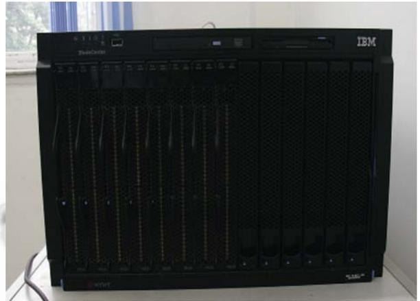
(a) 机器内连接有八个刀片服务器
