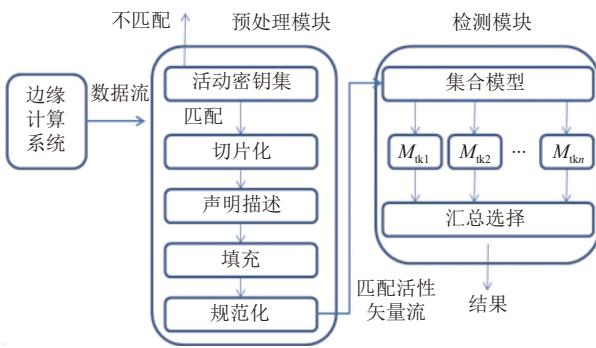
图 1 IoT Ensemble 网络异常检测框架
