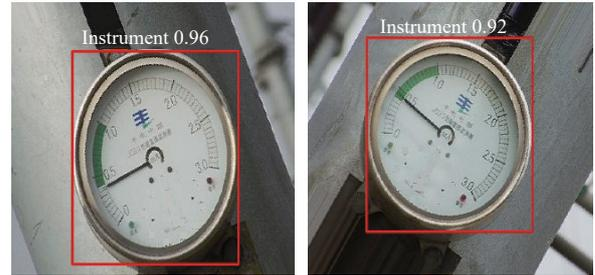
图 5 基于 YOLOv8 的仪表区域检测结果
