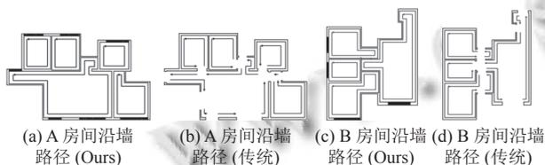
图 15 两种算法生成的毛坯房间沿墙路径
