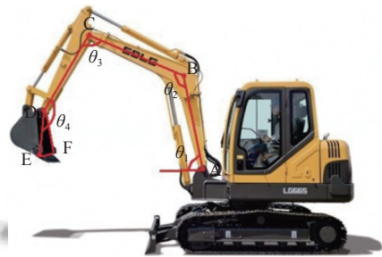
图 1 挖掘机工作装置示意图
