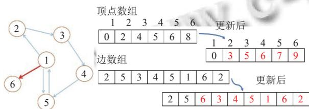
图2 简单图的 CSR 存储格式及其更新
