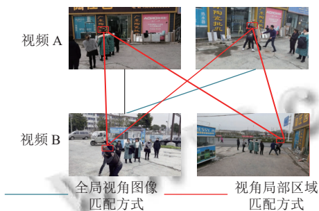
图6 全局图像和局部区域匹配方式的区别
