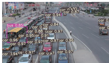
(a) 原 YOLOv5 检测结果
