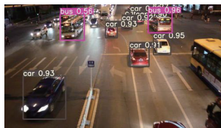
(a) 原 YOLOv5 检测结果
