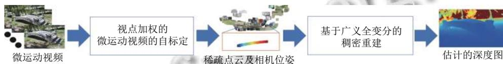
图2 提出的微运动视频三维重建方法的技术流程图.
