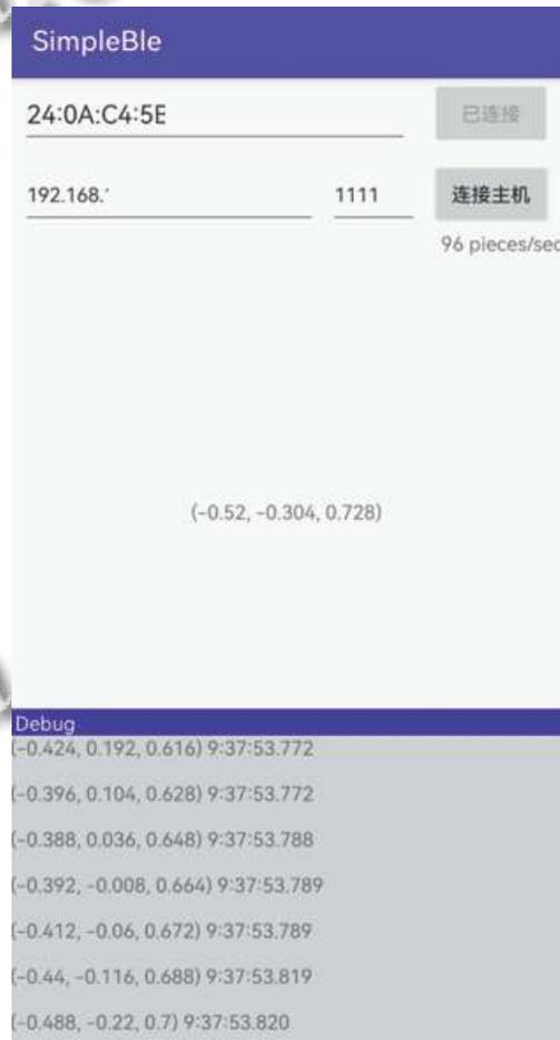
图 7 手机端实时显示运动数据和传输频率
