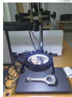
图7 发动机连杆质量多参数检测视觉系统
