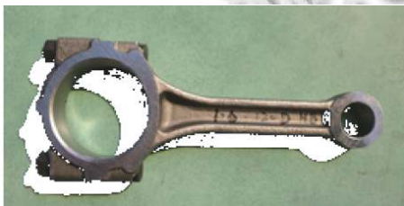
图3 基于多阈值分析的发动机连杆彩色图像阴影消除
