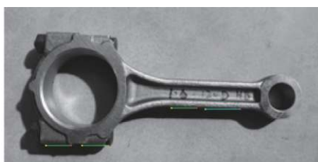
(b) 发动机连杆图像下边缘直线检测
