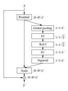
图 3 SE 模块的具体结构
