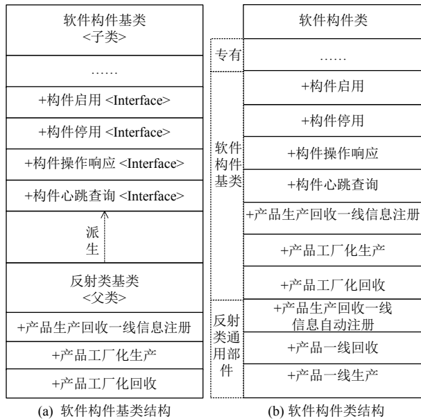
图5 软件构件基类和软件构件类结构
