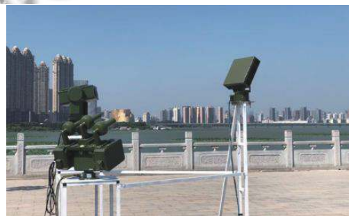
图 10 无人机探测设备搭建平台
